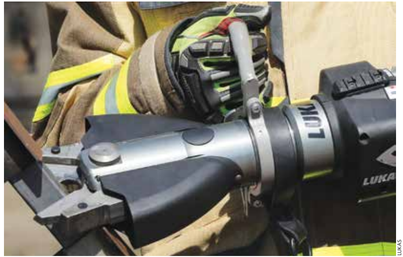
Kakovostna rezila, oblikovana v obliki srpa, imajo dolgo življenjsko dobo, menjavanje konic pa je zaradi velikih gumbov zaklepa preprosto.
