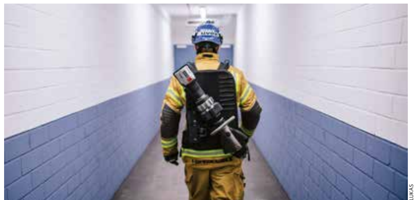
Serija Strongarm je vsestransko orodje za vlamljanje in odpiranje vrat, rezanje verig, ključavnic in palic, zaradi velike moči lahko tudi dvigne ali odrine oviro. Namenjena je manjšim enotam in policiji.
