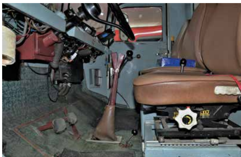
Bolj preprosto ne gre: mehansko vzmeten vozniki sedež, velikanska ročica ročne zavore – ob njej je ročica menjalnika, med sedežema pa ročica reduktorja.
