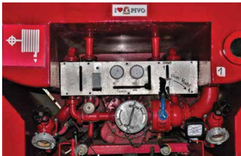
Črpalka z osnovnima instrumentoma je 'skrita' zadaj pod cisterno in ima pogon prek odгона moči na menjalniku.
