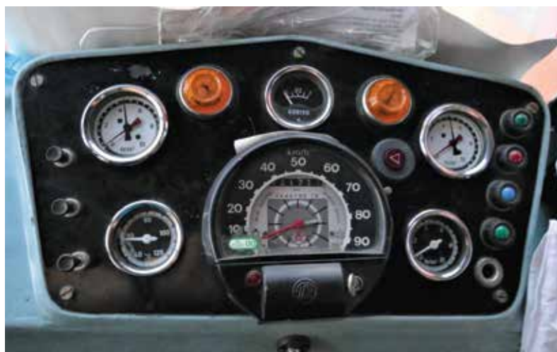
Armatura plošča postreže z osnovnimi podatki. Ker ni merilnika vrtljajev, mora voznik pretikati po posluhu.
