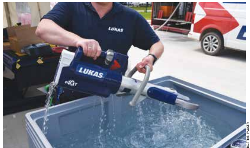
Reševalno orodje eWXT je zaščiteno pred vodo in omogoča delovanje v močnem dežju, ob morebitni poplavi in celo pod vodo.
